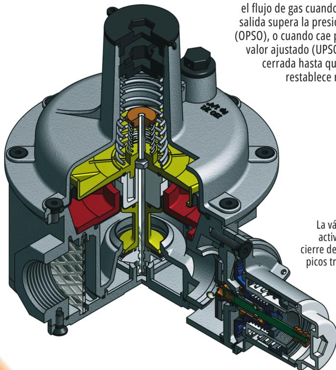
La válvula de cierre de seguridad corta el flujo de gas cuando la presión de salida supera la presión establecida (OPSO), o cuando cae por debajo del valor ajustado (UPSO). Permanece cerrada hasta que la válvula se restablece manualmente.
