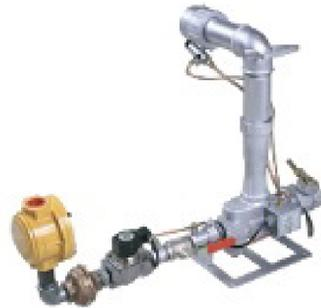
*Quemador de premezcla EQA 76 giratorio, con control de llama a termocupla o electrónico, filtro, para gas a baja presión. Dos modelos: de 100.000 y de 250.000 Kcal/h, con ventilador centrífugo de 1/2 hp.*
