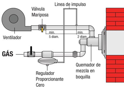
b) La presión de gas es **menor** que la presión de aire: En este caso se realiza una conexión igual a la anterior pero intercalando entre el regulador CERO y la línea de aire un Bleeder o expurgador, que permite obtener cualquier porcentaje entre 5% y 85%, de la presión de aire disponible. Esta forma de conexión se utiliza únicamente cuando la presión de la cámara de combustión es atmosférica.
