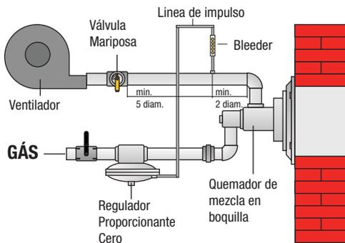
c) En el caso de presiones de horno diferentes de la atmosférica se utiliza para la línea de impulso el sistema de expurgue de aire de dos válvulas (o grifos).
