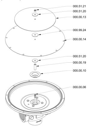
5-Retirar los tornillos (INS.87.11 o INS.87.14) que sostienen el cuerpo (000.00.02) y sacar la caja de diafragma (000.00.08), el diafragma de equilibrio (000.00.07) y el eje (000.00.06) con el obturador (000.00.05).
