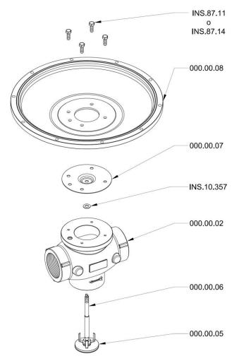
6-Observar el obturador (000.00.05), si esta marcado o tiene clavadas partículas debe ser reemplazado. Para ello retirar la tuerca (INS.10.362) del eje (000.00.06), con lo que se liberara el obturador (000.00.05).
